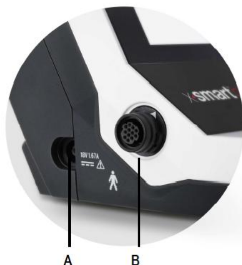
Рис.4 Разъем питания и мотора наконечника
